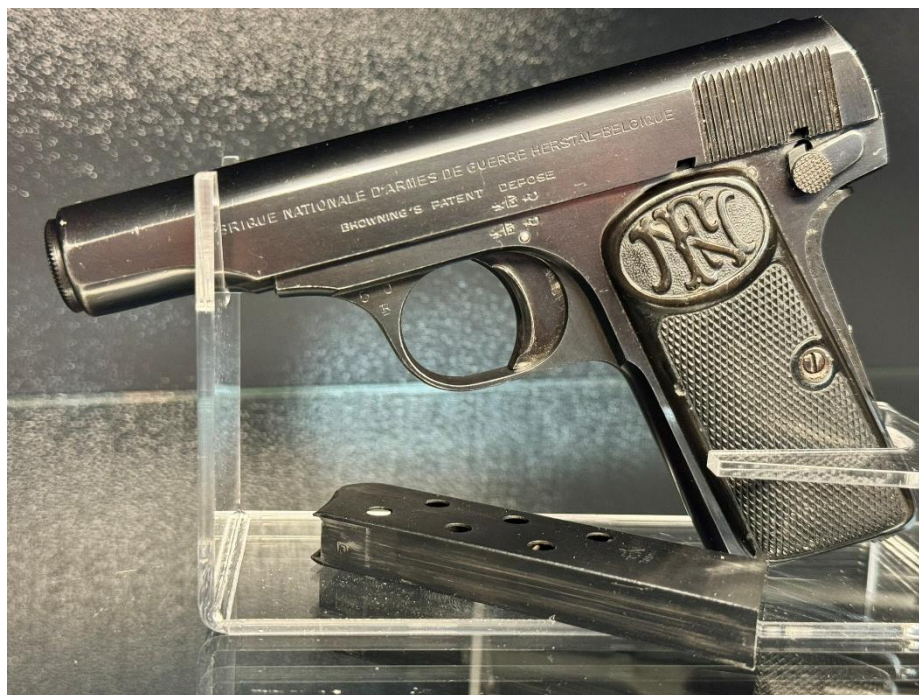
FN1910 in 7.65mm Browning - Quelle: Privataufnahme des Autors
