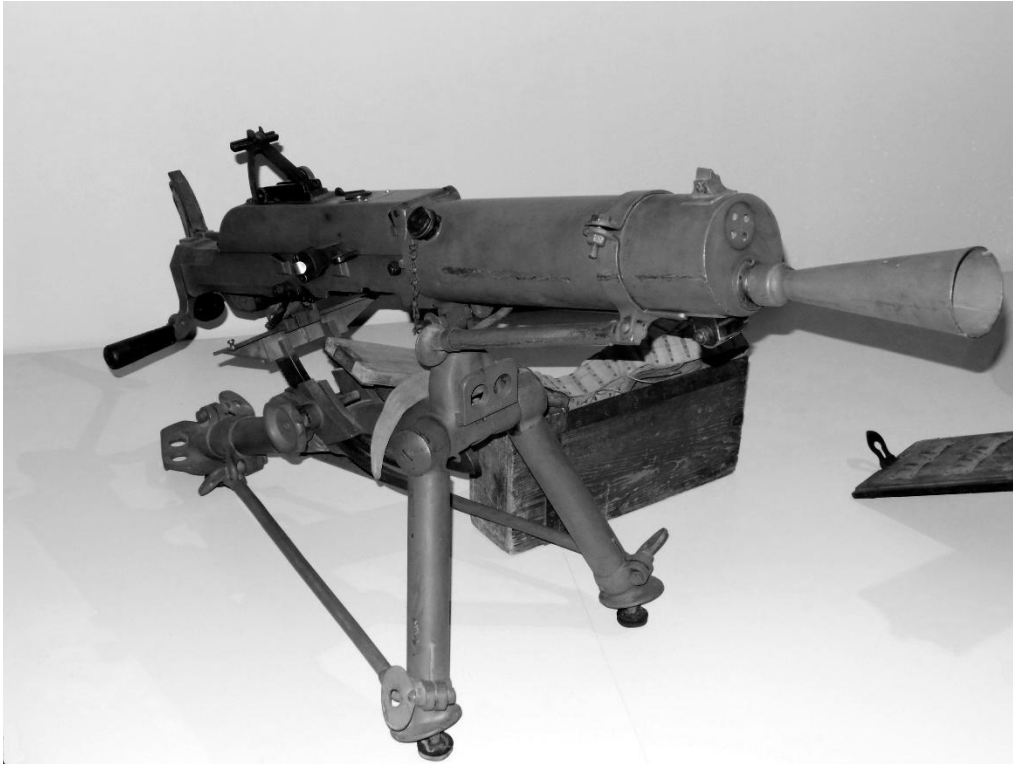
Schwarzlose M07/12 mit Munitionskasten und Textil-Munitionsgurt, Aufnahme am 13. November 2015. Lizenz: CC BY-SA 4.0.
