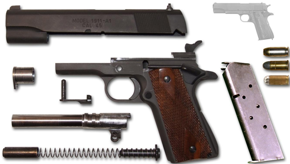
Abb. 2: Springfield 1911-A1 (Mil Spec), Kaliber .45 ACP, teilzerlegt. Foto: Jan Hrdonka (Hrd10); Bildbearbeitung: Auge=mit. Lizenz: CC BY-SA 4.0, via Wikimedia Commons.
